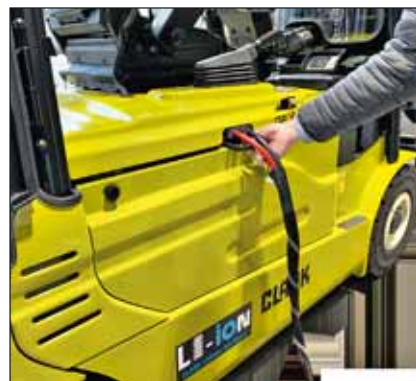
Das Ladegerät mit 80 V lädt die Batterie in gut 3,5 Stunden vollständig wieder auf. Fotos: Clark Europe
