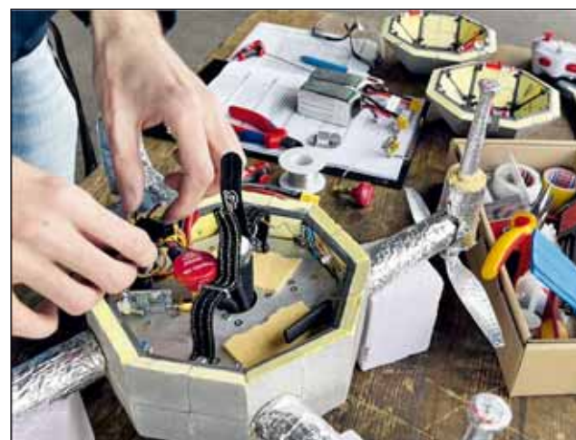
Das glasfaserverstärkte Aerogel umschließt das Herz der Drohne und schützt damit die Stromversorgung und die Elektronik vor Hitze.
