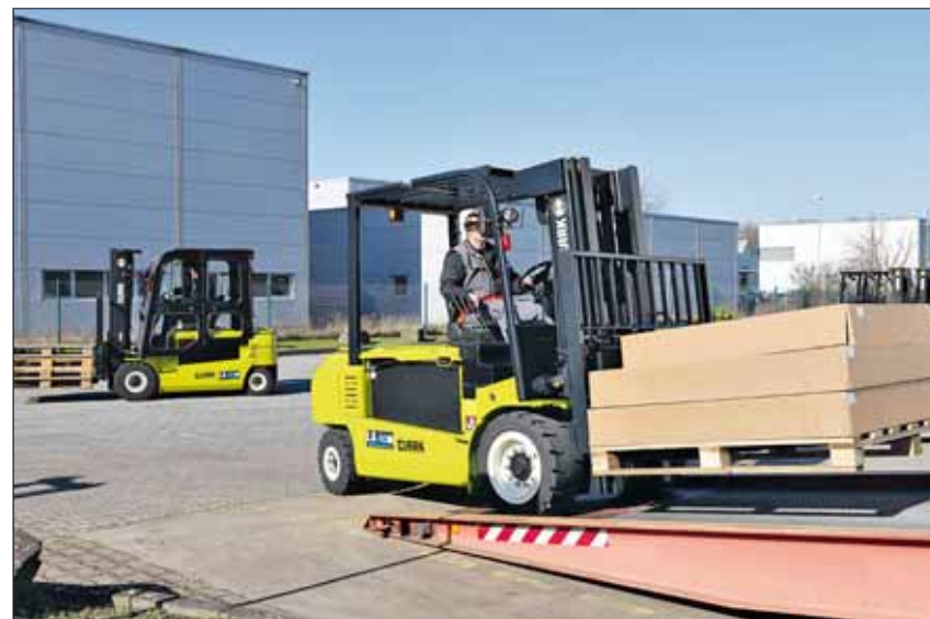
Zwei Fahrmotoren im Parallelfrontantrieb mit jeweils 7,8 kW Leistung bei der Baureihe „GEX 20-30L“ und 11,3 kW bei der Reihe „GEX 40-50“ zusammen mit einer 80 V starken Drehstrom-Technologie garantieren eine zügige Beschleunigung und hohe Schubkraft. Den sicheren Einsatz auf abschüssigem Gelände oder Rampen stellt die serienmäßige Rampenfunktion sicher, die ein unbeabsichtigtes Beschleunigen oder Zurückrollen des Staplers verhindert.
