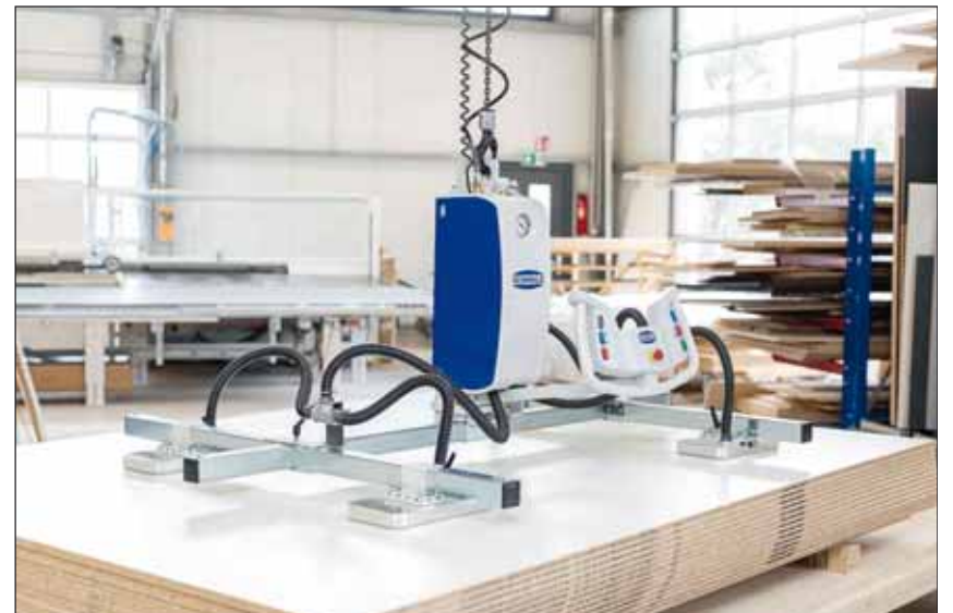
Das neue Gerät ist leichter und kompakter als das Vorgängermodell des Herstellers, das die Schreinerei Rothfuß im Einsatz hatte. Ebenso hat sich die Handhabung durch das „Comfort“-Bedienelement deutlich erhöht. Fotos: Schmalz
