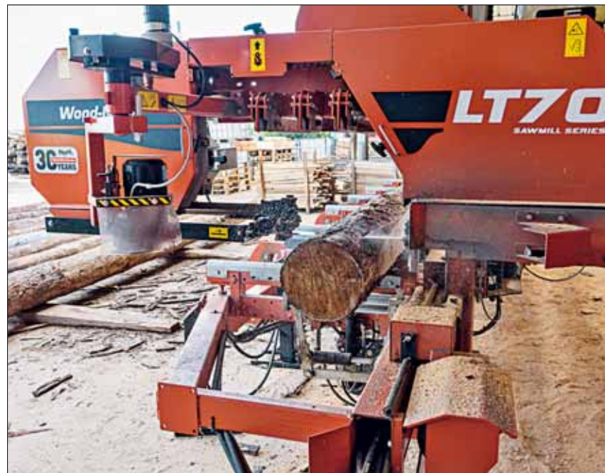
Das Wood-Mizer-Sägewerk „LT70“ auf dem Timbercut-Betriebsgelände in Sölllichau beim ersten Schnitt an einem Lärchenstamm.
