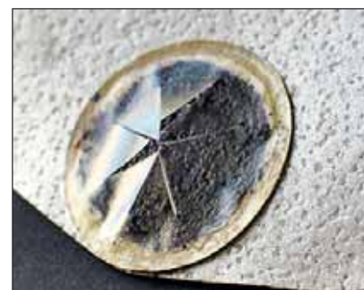
„Sensor-Blüte“: Der Schutzfilm aus Nanocellulose über dem Sensor (hier zur Erfassung des pH-Wertes) öffnet sich wie eine Blüte, sobald er mit Feuchtigkeit in Berührung kommt – und der Sensor beginnt seine Arbeit.
