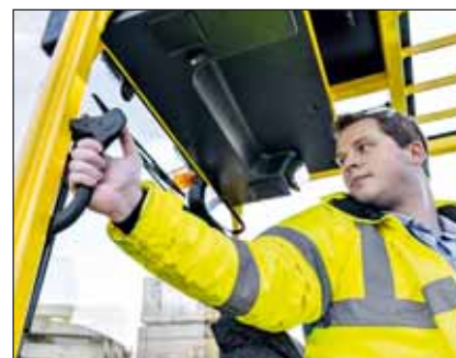
Das Festhalten des Handgriffs veranlasst den Fahrer, beim Rückwärtsfahren in Fahrtrichtung zu blicken. Registriert das System die Hand am Griff, wird die Drosselung der Fahrgeschwindigkeit aufgehoben.
