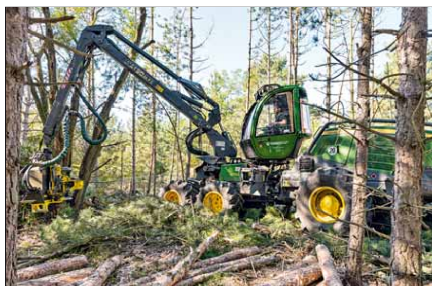
Die Aktivitäten der Harvester, hier ein John Deere „1070G“ und ein Aggregat „H413“ bei der Durchforstung von Schwachholz in einem Schwarzkieferbestand, werden mit einer selbst angepassten Lösung automatisch getrackt.
