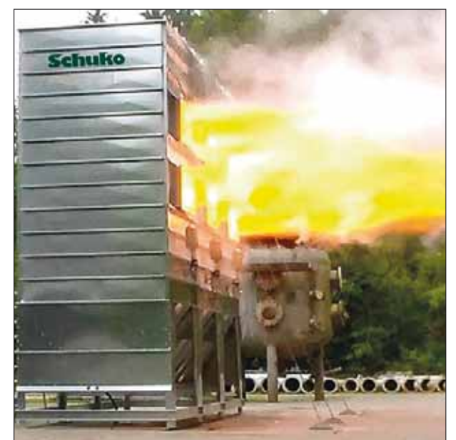
Explosionsprüfung bei einer einer „Validus“-Filteranlage von Schuko Foto: Schuko
