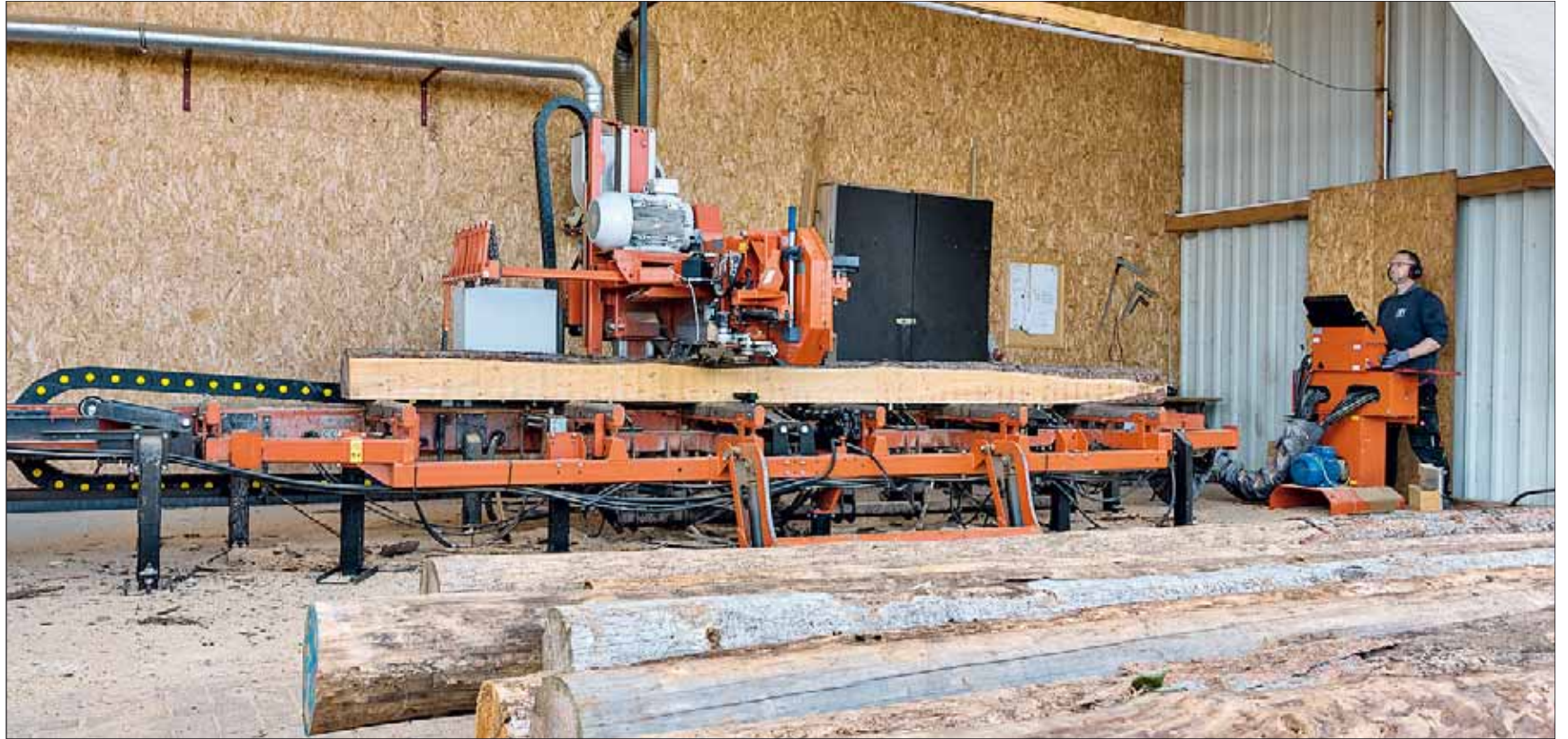
Das Sägewerk des Forstbetriebs kann Stämme bis zu 5 m Länge und 60 cm Dicke zu Schnittholz aufbereiten.
