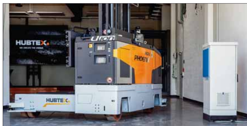
Mit dem induktiven Ladesystem von Intis kann der „Phoenix AGV“ mit einem Ladestrom von 400 A berührungslos geladen werden. Ladepads am Fahrzeug interagieren automatisch mit Ladepads auf dem Boden oder an den Wänden, sobald das Fahrzeug entsprechend positioniert ist. Foto: Hubtex
