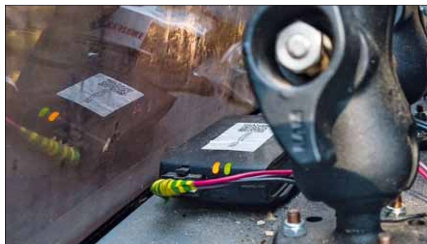
In Fahrzeugen und in allen Forstmaschinen der Flotte ist ein GPS-Tracker zur Georeferenzierung verbaut.
