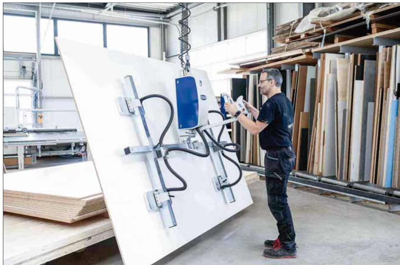
Schreiner Alexander Bohnet handhabt mit dem „Vacumaster Wood“ ergonomisch bis zu 250 kg schwere Platten. Nach der Anlieferung kommen die Holzplatten in den Zuschnitt. Die Schwenkfunktion erlaubt es dem Schreiner, die liegend angelieferten Platten oder späteren Reststücke direkt aufrecht ins Regal zu schieben.
