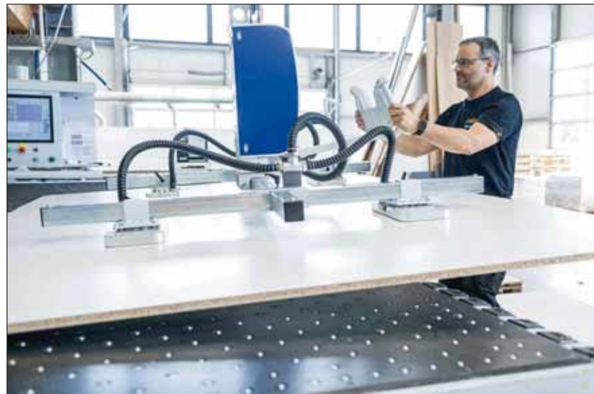
Mit der Investition in eine liegende Plattensäge zog auch die erste Hebehilfe bei Rothfuß ein. Seit neuestem hebt ein „Vacumaster Wood“, der hier im Feldtest war, das Holzhandling auf die nächste Ergonomie-Stufe.
